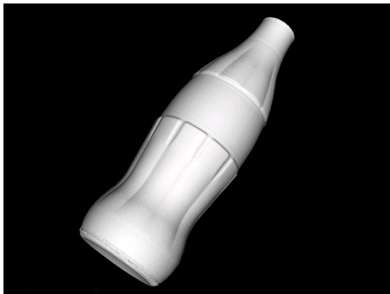
Fig. 1: Modello 3D ottenuto con scansione laser a ciclo automatico
