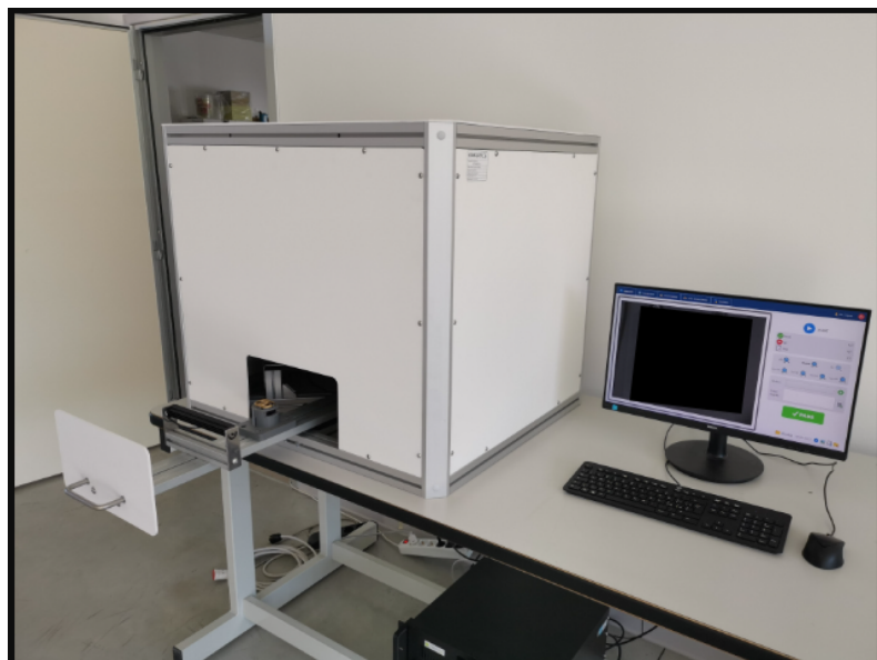
Fig. 1: Sistema Controllo Qualità Componenti Estetici: 4 telecamere alla base e 1 in alto
