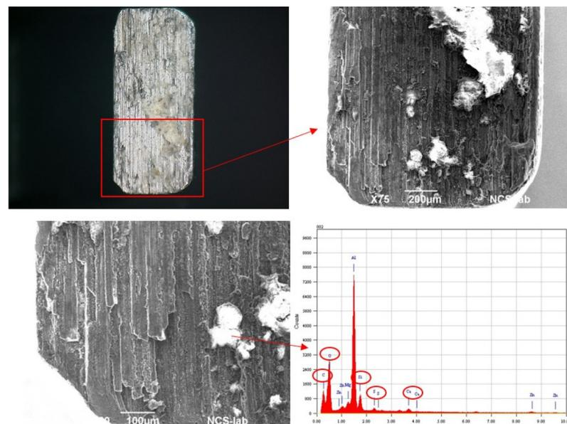
Fig. 1: Analisi frattografica in microscopia elettronica SEM-EDS
