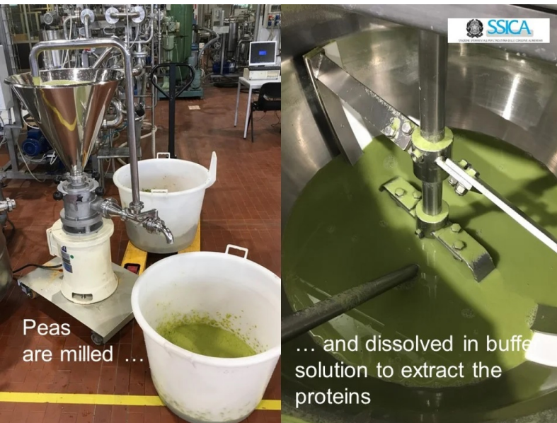
Fig. 2: Estrazione su impianto pilota SSICA
