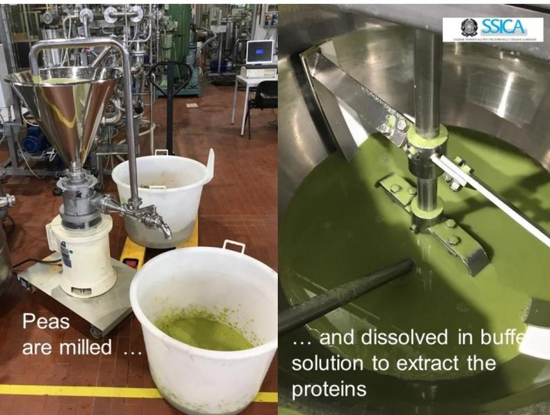
Fig. 2: Estrazione su impianto pilota SSICA
