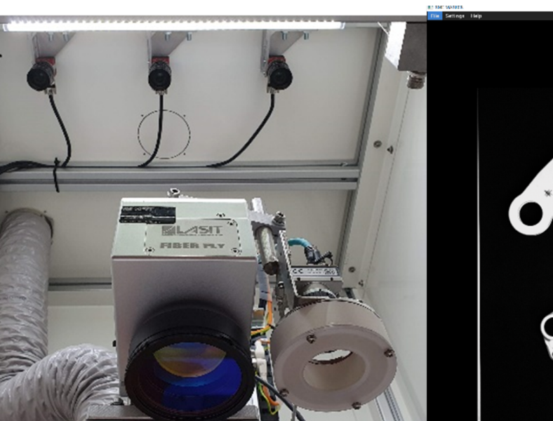
Fig. 2: Array di camere installate all'interno della marcatrice LASIT, GUI del Software MUSP per controllo macchina e riconoscimento dei pezzi
