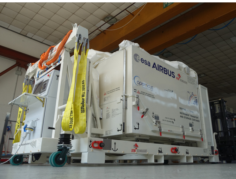
Fig. 3: Transport container per strumenti per satelliti (Sentinel 5)
