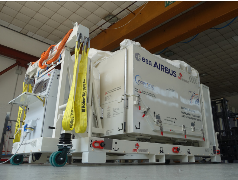
Fig. 2: Transport container per strumenti per satelliti (Sentinel 5)
