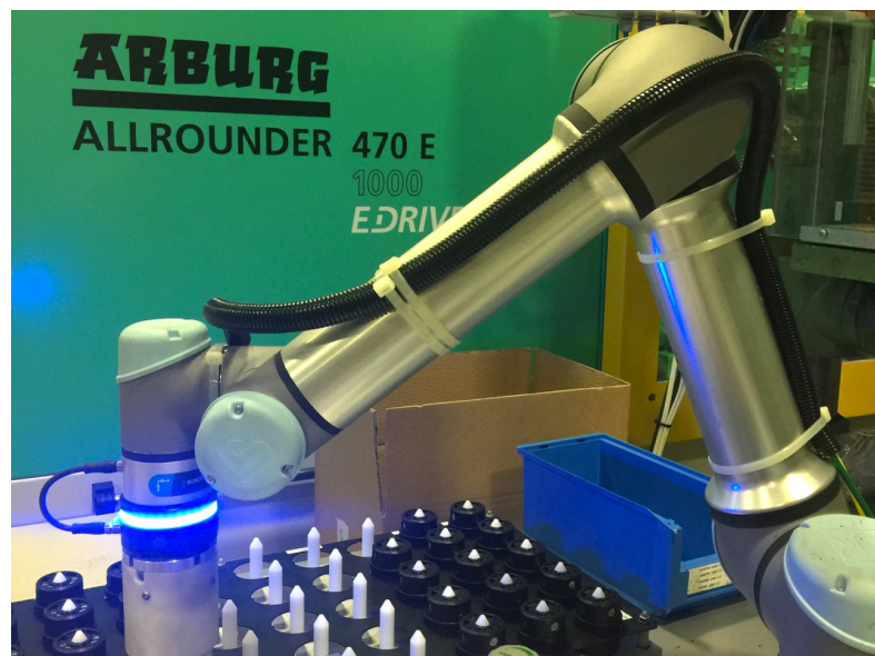
Fig. 1: Cobot Pick, Place, Check, Pack - il cobot attualmente esegue le seguenti attività: pick&place su stazione di controllo polarità, place su buffer e su posatore per barenatura e imballaggio (4su7 CL)
