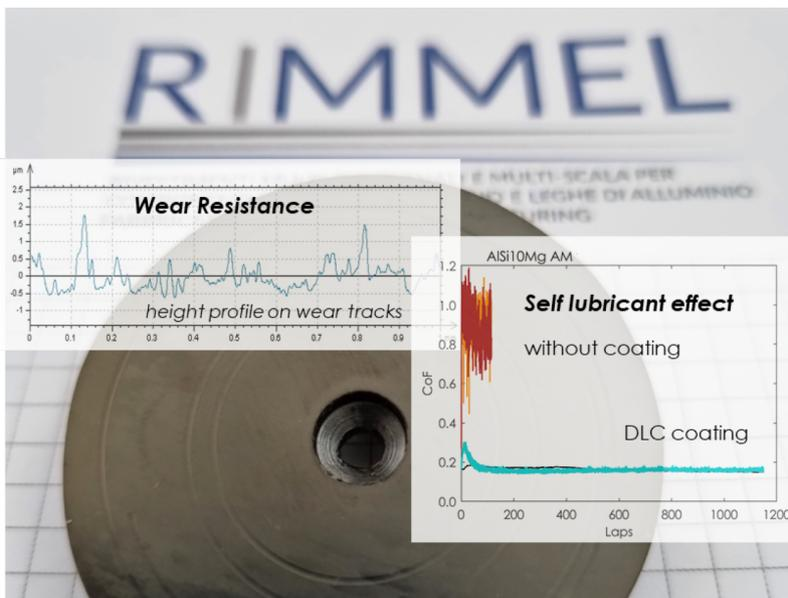
Fig. 3: Rivestimento multistrato con terminazione DLC su disco in lega AISI10Mg realizzato in Additive Manufacturing. Risultati dei test tribologici in configurazione ball on disc
