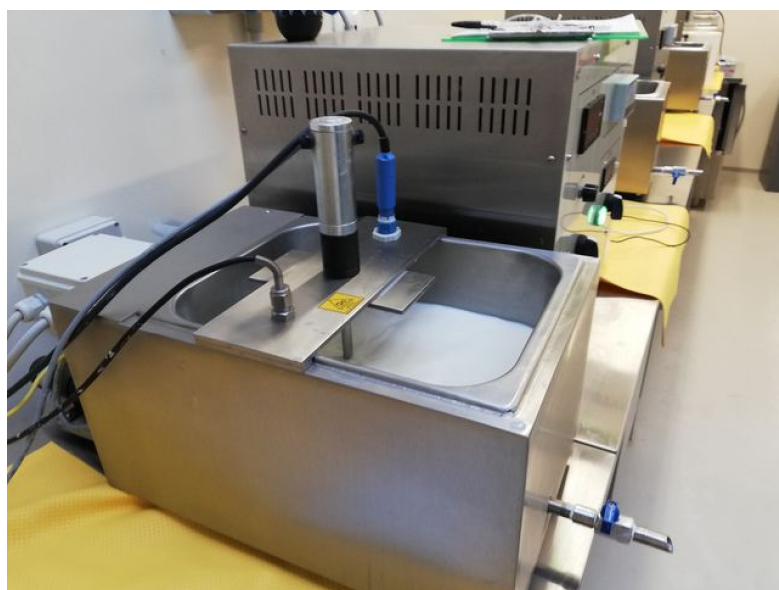
Fig. 1: Caldaia pilota della sala lattiero-casearia CRPA Lab in funzione
