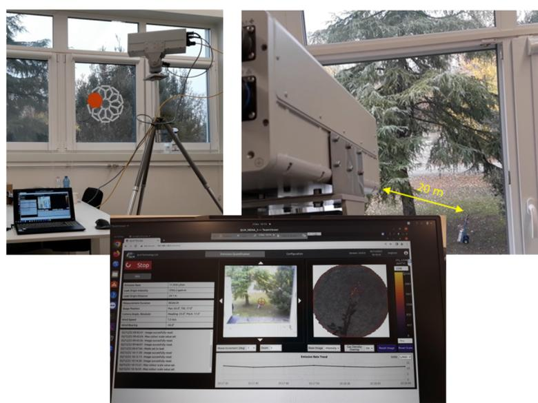
Fig. 3: CASO STUDIO 2: Identificazione a distanza di una fuoriuscita di gas naturale da bombola certificata.
