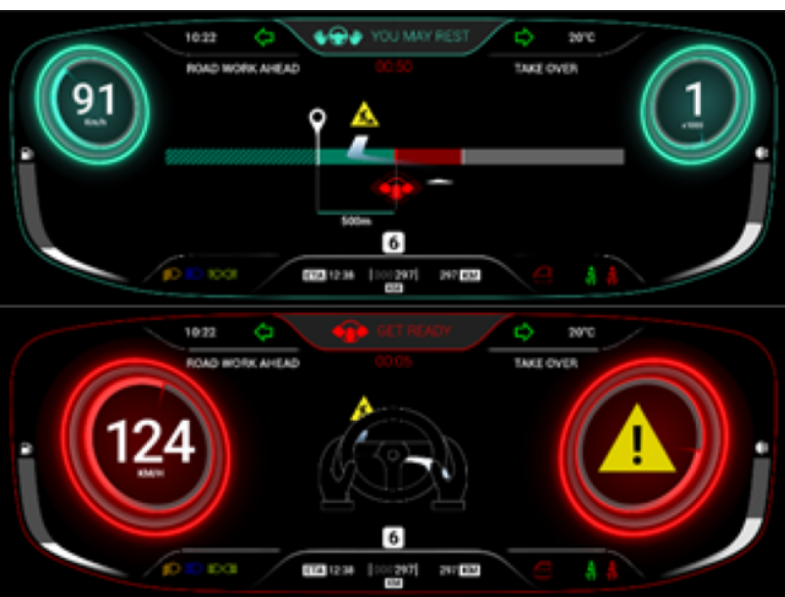
Fig. 2: Human-Machine Interface (HMI) intelligente, in grado di assistere il conducente in modalità automatizzata in vari livelli di automazione in base allo stato del conducente.
