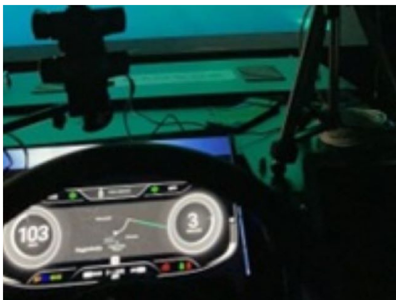
Fig. 1: Simulatore con telecamere e HMI adattativa allo stato del guidatore.
