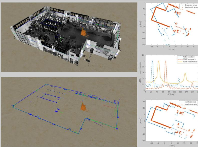
Fig. 2: Mappa e localizzazione di AGV tramite registrazione.
