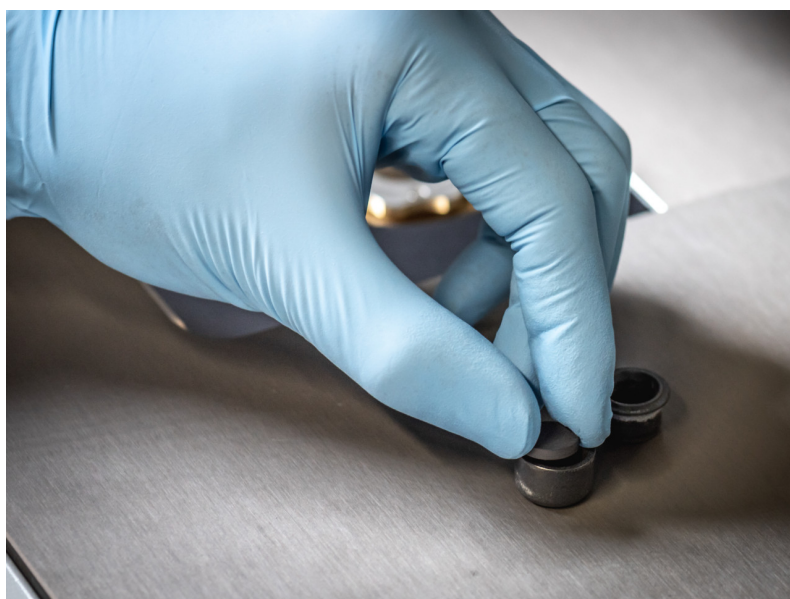
Fig. 1: Esempio di Provino per caratterizzazione termofisica mediante metodo dell'impulso luminoso
