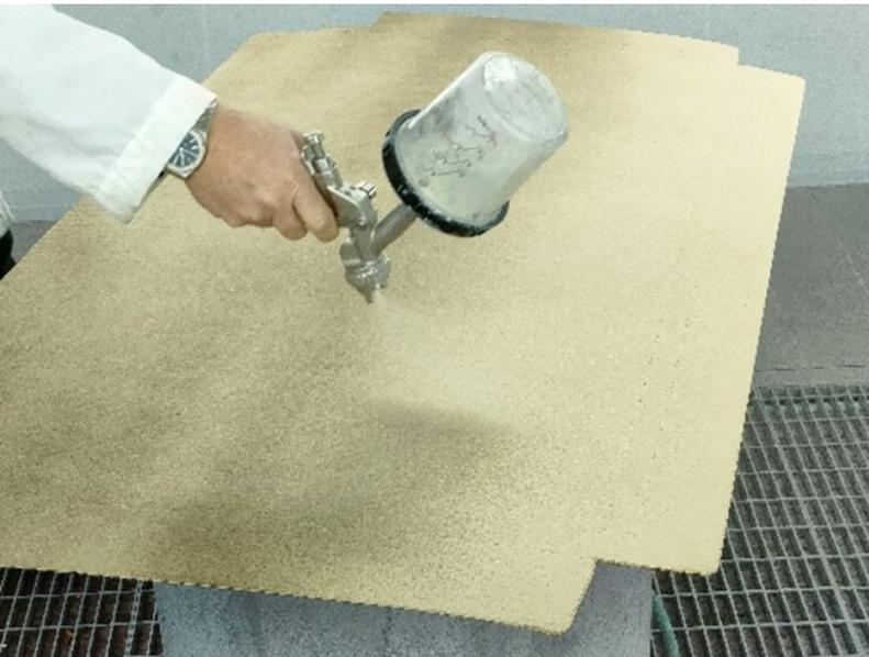
Fig. 2: Figura 2: Applicazione Polysil Paper mediante spruzzatura su cartone
