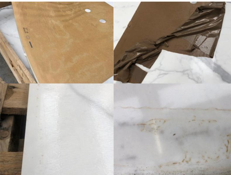
Fig. 3: Interfaldia trattata (alto a sinistra) vs. non trattata (alto a destra). Superficie della lastra a contatto con l'interfaldia trattata (basso a sinistra) e con interfaldia non trattata (basso a destra)
