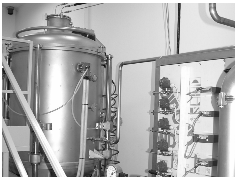
Fig. 1: Impianto pilota ENEA CVI/CVD
