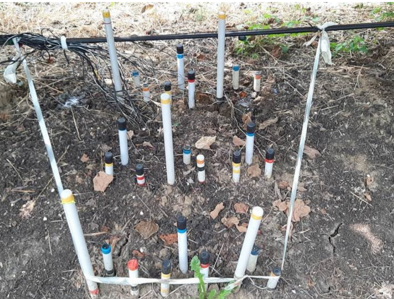
Fig. 2: Il sistema di sensori rileva l'umidità del terreno
