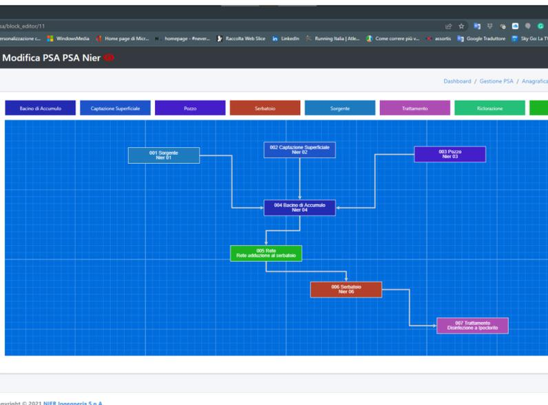
Fig. 3: Interfaccia di configurazione di un sistema acquedottistico
