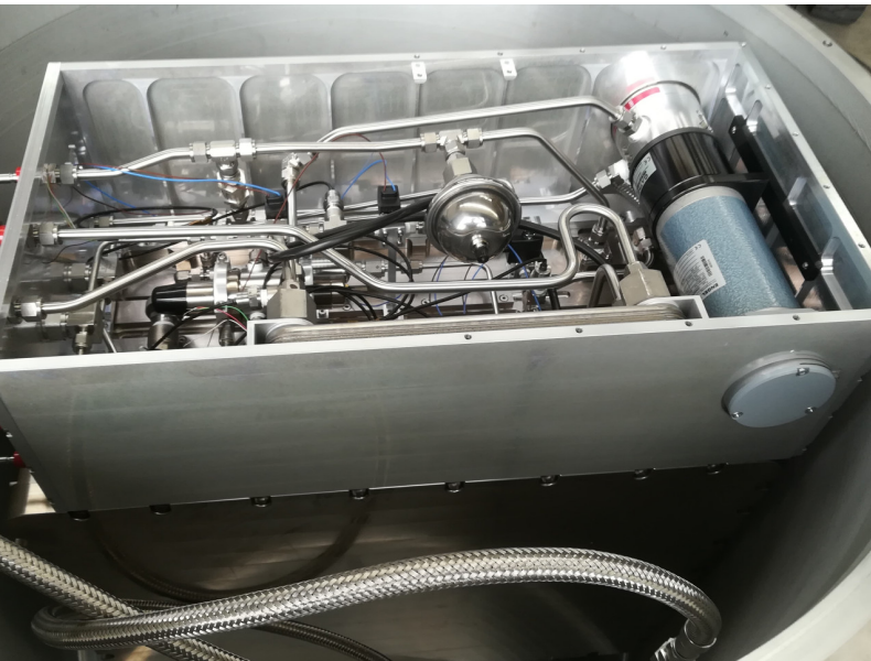
Fig. 2: 3DP durante test di tenuta in camera da vuoto
