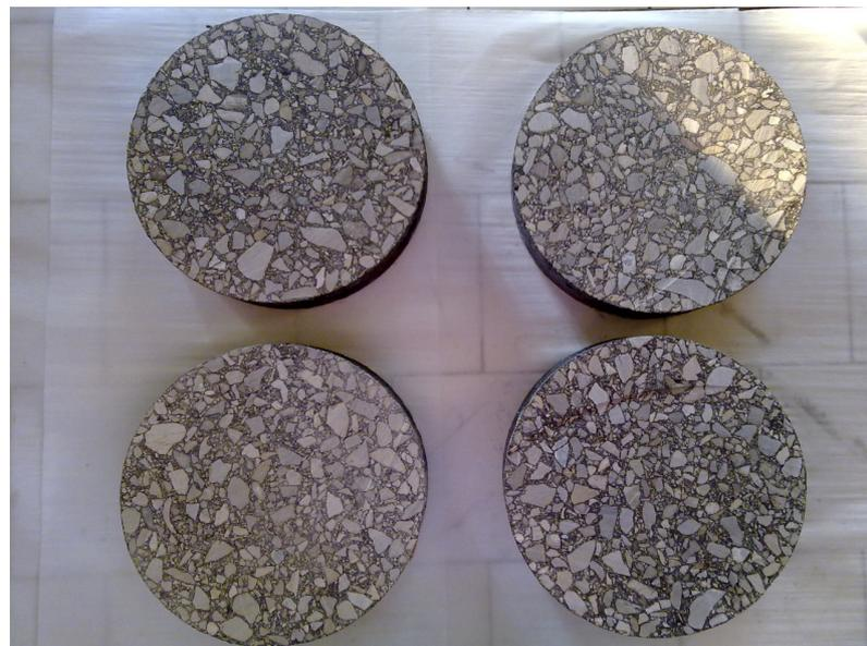
*Fig. 1: Provini di conglomerato bituminoso ad alte percentuali di materiale riciclato*
