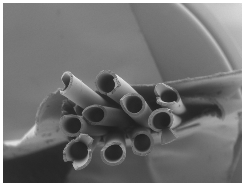
Fig. 1: Sezioni di fibre acquisite al SEM
