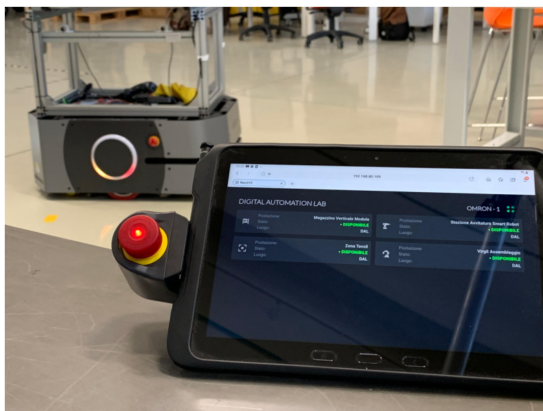
Fig. 1: interfaccia per guida Point to Point di AMR sviluppata al DAL
