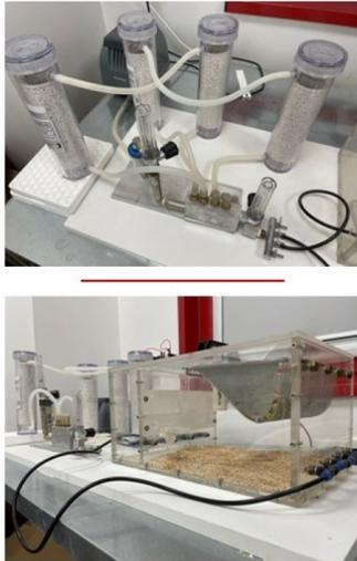
*Fig. 2: Chamber for Environmental Control per modelli sperimentali di occhio secco*
