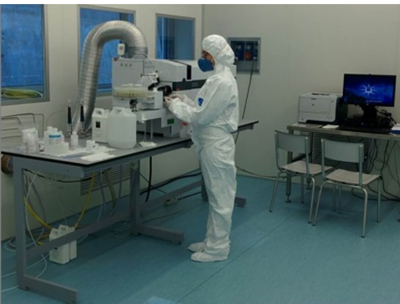
Fig. 2: Spettrometro di massa al plasma accoppiato induttivamente triplo quadrupolo in camera bianca ISO6, presso ENEA Brasimone (Sezione NUC-TNMT)
